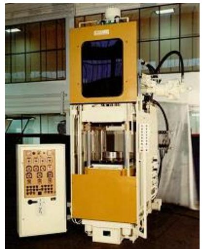
**N**otre atelier de production pour le moulage par injection et compression est composé de presses de tonnage divers à fin de garantir efficacité et réalisation des composants produits.
